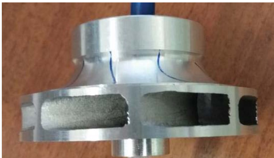
Рисунок 2. Отливка НП “Колесо”.
