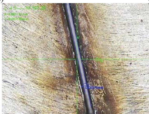
Рисунок 7 - Измерение реза в стали 12Х18Н10Т ГОСТ 5632-7, \times 700 : а) вход луча, ширина 66,83 мкм, измеритель - Keyence VHX-1000; б) выход луча, ширина 29,40 мкм, измеритель - Keyence VHX-1000. в) паз на просвет, ширина 27,50 мкм, измеритель - Norgay NVM-3020D.
