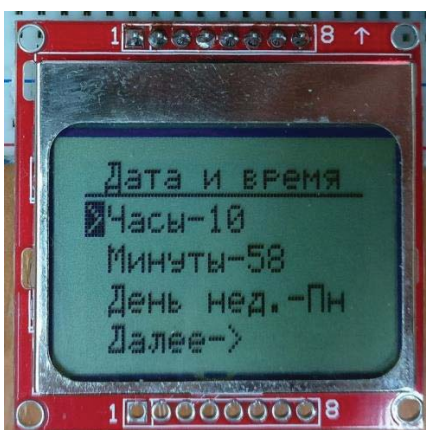
Рисунок 6. Пример настройки текущего времени
