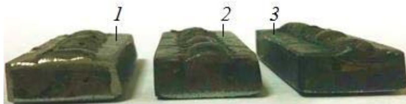
1 - однослойная наплавка; 2 - двухслойная наплавка; 3 - трехслойная наплавка
