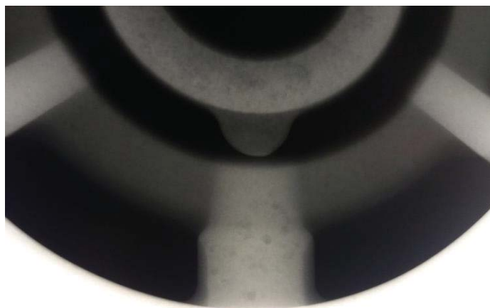
Рисунок 1 а. Рыхлота и пористость
