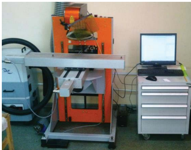
Рисунок 1 - Стационарный комплекс лазерной маркировки LDesigner F2.
