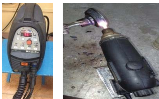
а) - сварочный аппарат MinarcTIG; б) - мультиплаз- 2500
