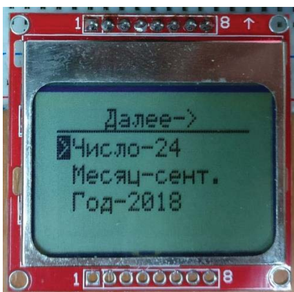
Рисунок 5. Пример настройки текущей даты
